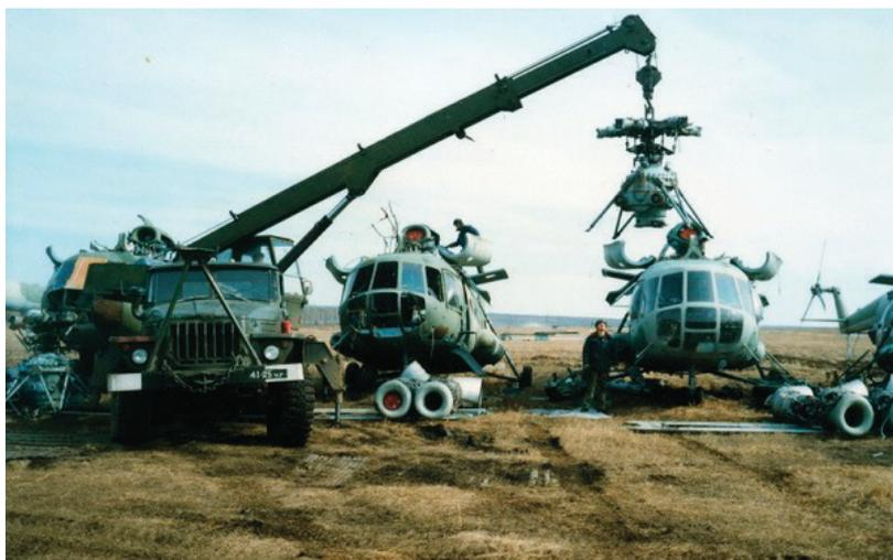
Рис. 1. Демонтаж оборудования вертолетов
