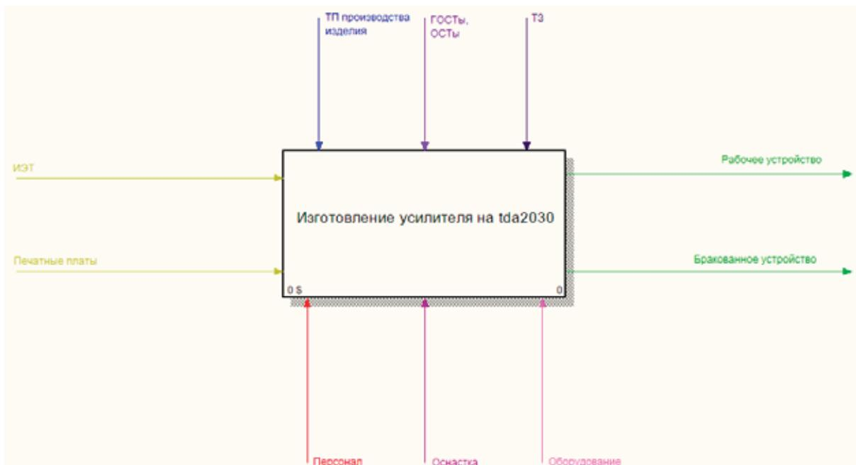
Рис. 3. Контекстная диаграмма ТП изготовления усилителя на TDA2030
