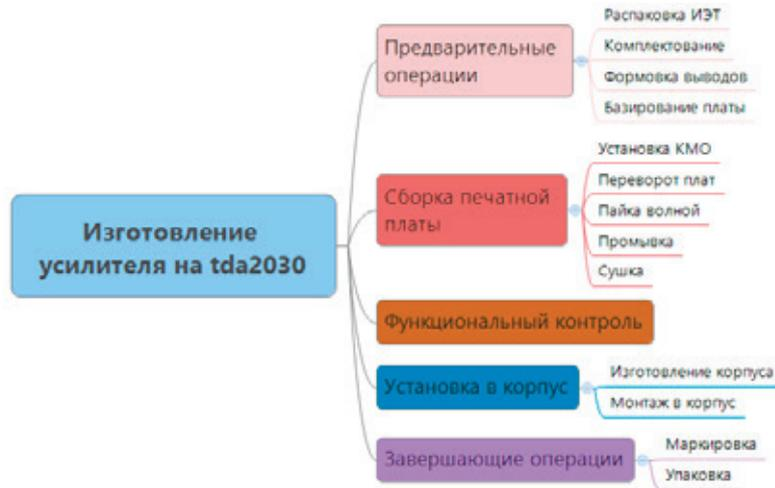
Рис. 2. Концептуально-абстрактная модель усилителя на TDA2030
