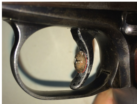
Рисунок 1 – Канцелярская кнопка, присоединенная к спусковому крючку пистолета Макарова.
