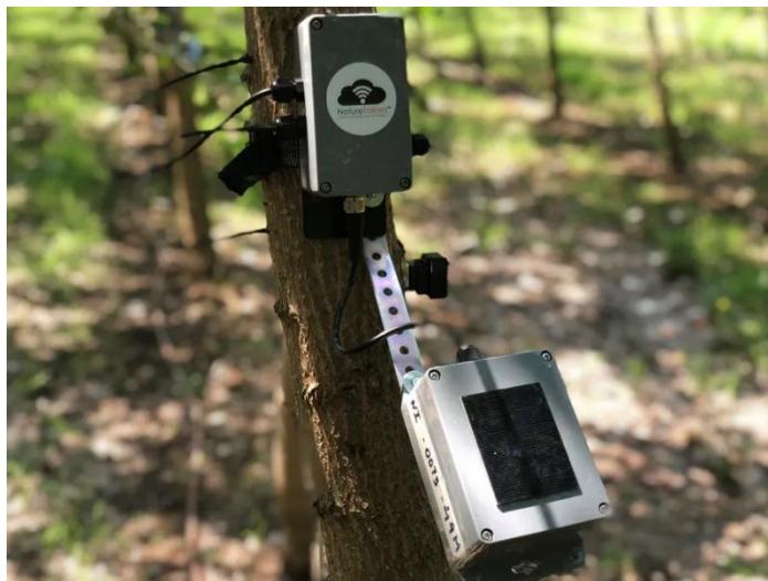
Рис. 4. Датчик состояния растительности TreeTalker
