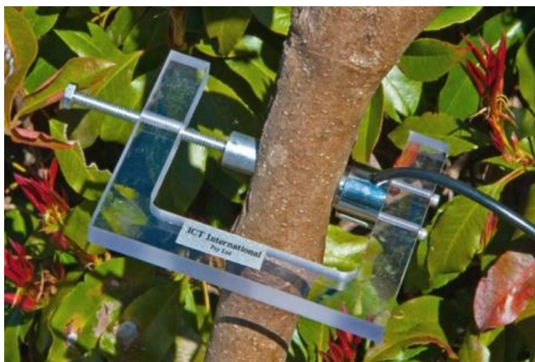
Рис. 2. Психрометр PSY1 с зажимом PSY-LC
