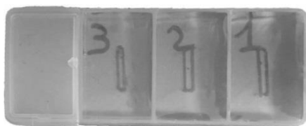
Рис. 3. Изготовленные образцы для измерения твердости
