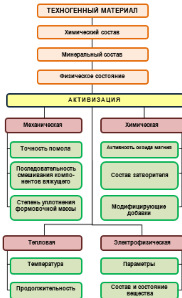
Рис. 2. Схема оценки и способы активизации техногенного компонента смешанных магниевых вяжущих
