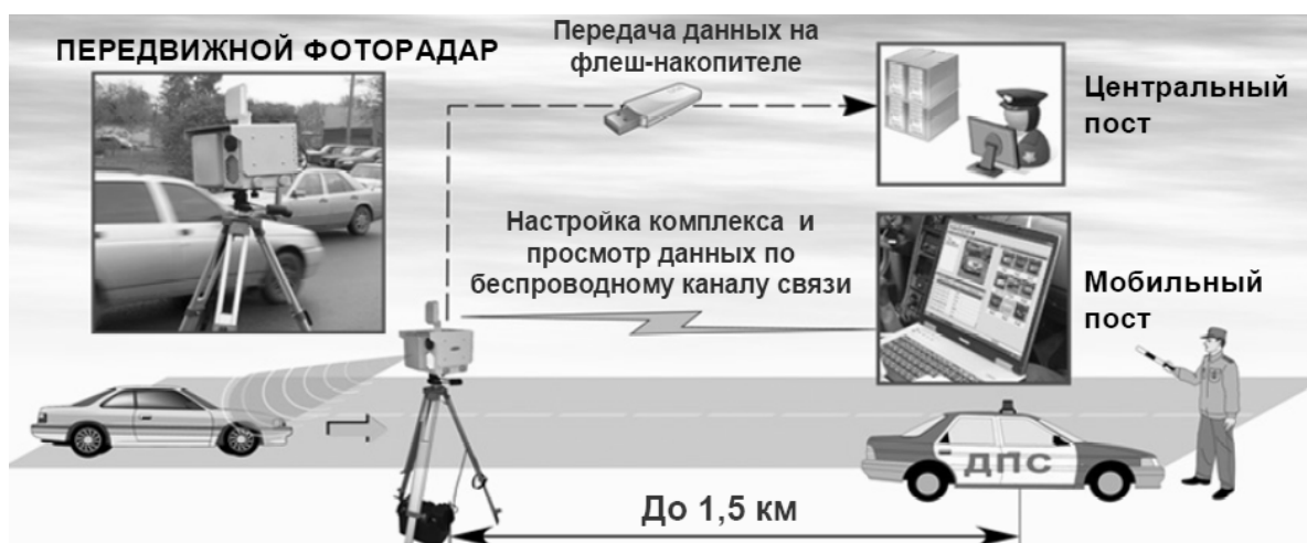
Рис. 1. Принцип работы прибора «КРИС-П»
