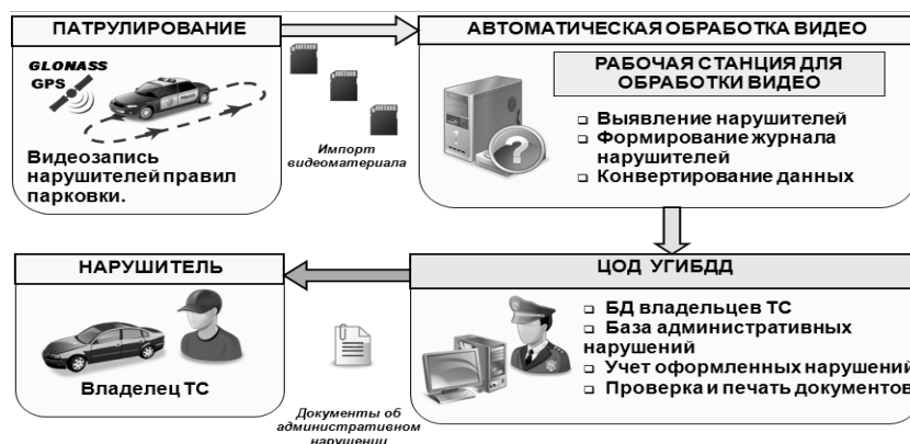
Рис. 4. Принцип работы «ПАРКОН»
