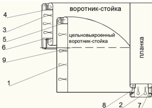
Рис. 5. Технический рисунок конструктивных узлов «воротник-горловина» и «застежка» женского демисезонного пальто из тонкосуконной пальтовой ткани, выработанной сложным двухслойным переплетением (способ 1)
