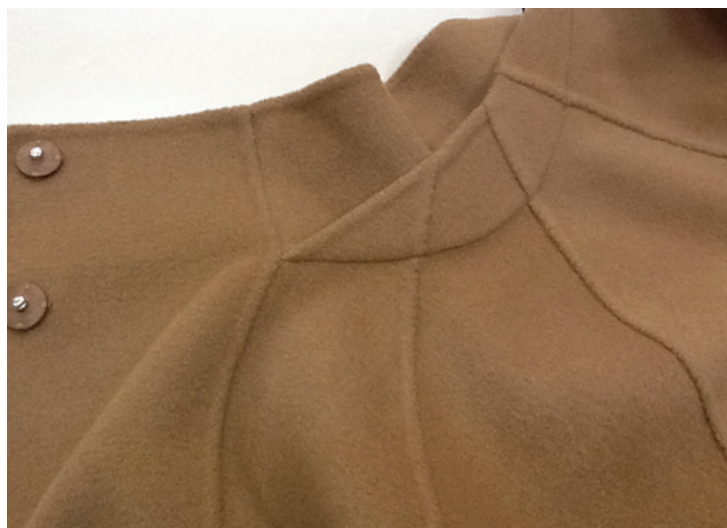
Рис. 3. Внутренний цельновыкроенный воротник-стойка и застежка (притачная планка) женского демисезонного пальто из тонкосуконной пальтовой ткани, выработанной сложным двухслойным переплетением (вид с изнаночной стороны)
