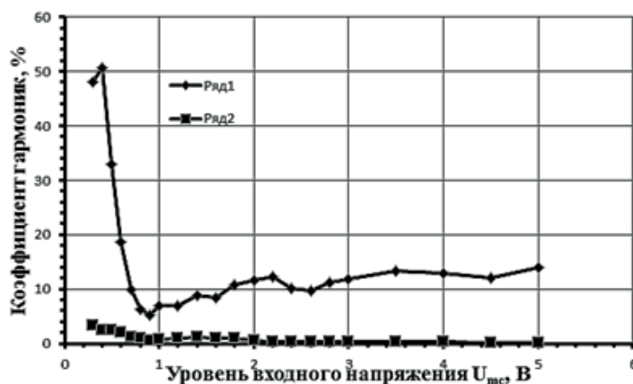
Рис. 7. Зависимость коэффициента гармоник от уровня входного АМ сигнала: ряд 1 – диодный детектор АМ сигналов, ряд 2 – синхронный детектор АМ сигналов.
