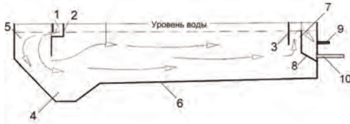
Рис.1. Общий вид горизонтального отстойника
