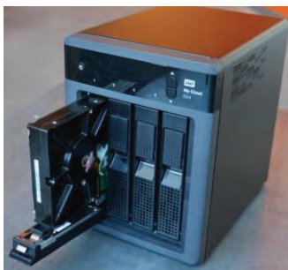
Рис.3. Установка жесткого диска в модификацию My Cloud, с возможностью установки до четырех жестких дисков.
