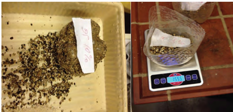
Рисунок 2 - образец грунта и процесс взвешивания пород при нагревании.
