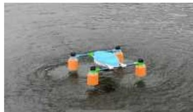
Рис. 5. БВС – носитель интегральной АПО мониторинга с функцией приводнения
