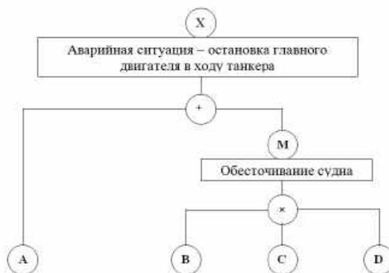
Рис. 2. Дерево отказов для аварийного случая «Остановка главного двигателя» в ходу судна
