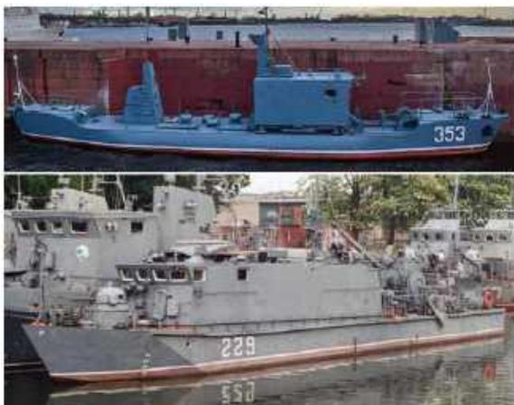
Рис. 3. Речной рейдовый радиоуправляемый прорыватель минных заграждений пр. 13000 (сверху) и его катер-водитель пр. 12255 (снизу)
