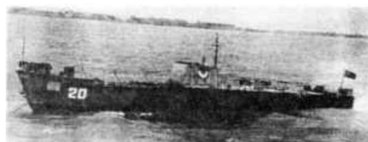
Рис. 2. Радиоуправляемый катер-цель пр. 383 [5]
