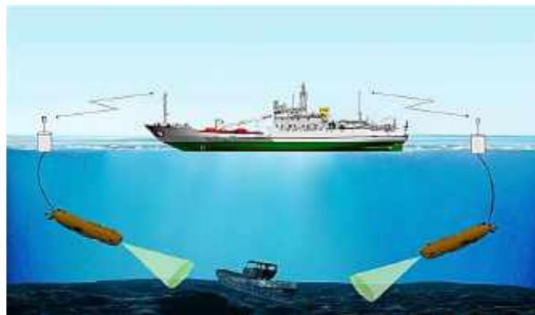
Рис. 5. Вариант организации одновременного управления работой группы ТНПА с использованием технологической радиосети
