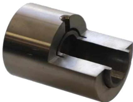
Рис. 5 Разрезанный испытательный образец
