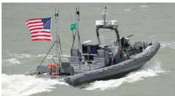
Рис. 5. БЭК специального назначения ВМС США на базе жестко-корпусной надувной лодки
