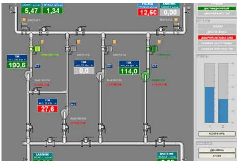
Рис. 1. Визуализация в SCADA системы работы насосной станции
