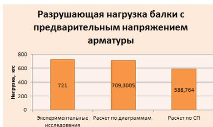
Рис. 4 Сравнение результатов расчета и экспериментальных исследований по разрушающей нагрузке балки с п.н.
