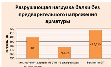
Рис. 3 Сравнение результатов расчета и экспериментальных исследований по разрушающей нагрузке балки без п.н.
