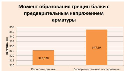
Рис. 5 Сравнение результатов расчета по моменту образования трещин по фактическим размерам и экспериментальным исследованиям
