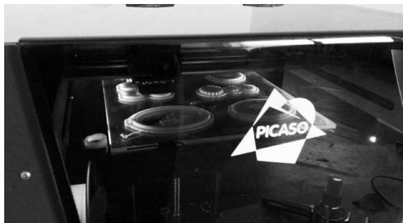
Рис. 1. Печать деталей на 3D принтере
