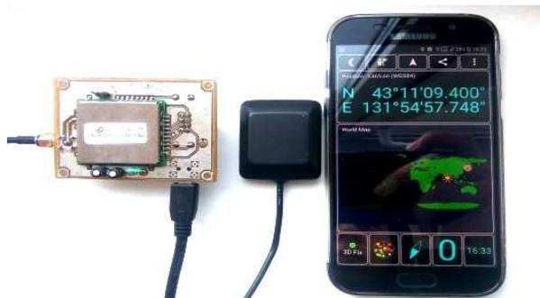
Рис. 4. Расположение двух приемников ГеоС-1М и Samsung galaxy A5 во время замера
