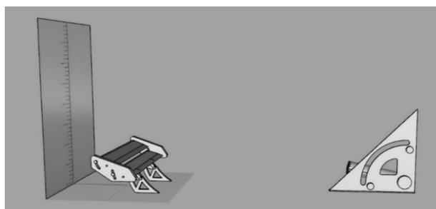
Рис. 5. Конструкция для установки угла атаки антикрыла
