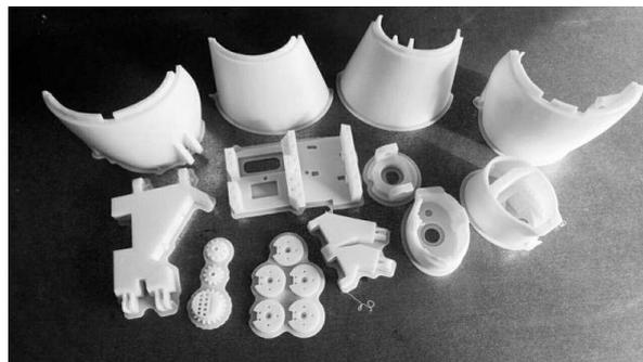
Рис. 2. Напечатанные детали
