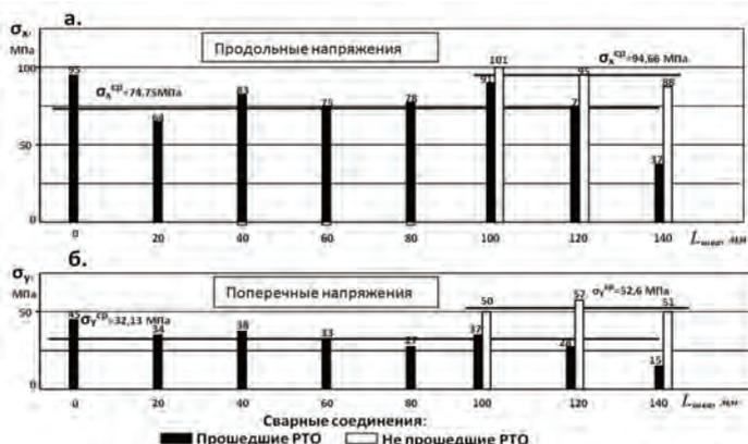
Рис. 3. Распределение продольных  $\sigma_x$  (а) и поперечных  $\sigma_y$  (б) остаточных сварочных напряжений в прошедшем РТО и необработанном стыковых швах сплава АД31Т
