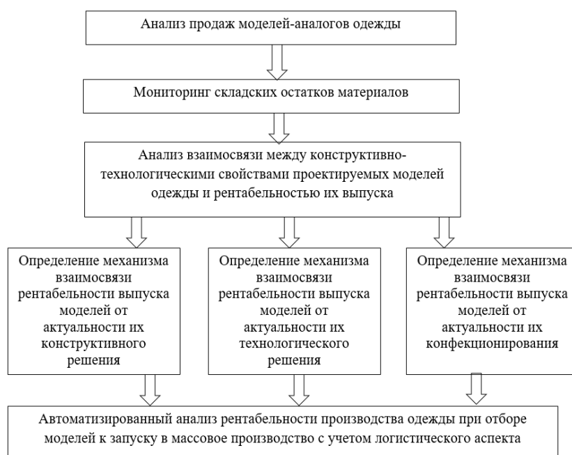
Рис. 1. Обобщенный алгоритм автоматизированного анализа рентабельности производства одежды при отборе моделей к запуску в массовое производство
