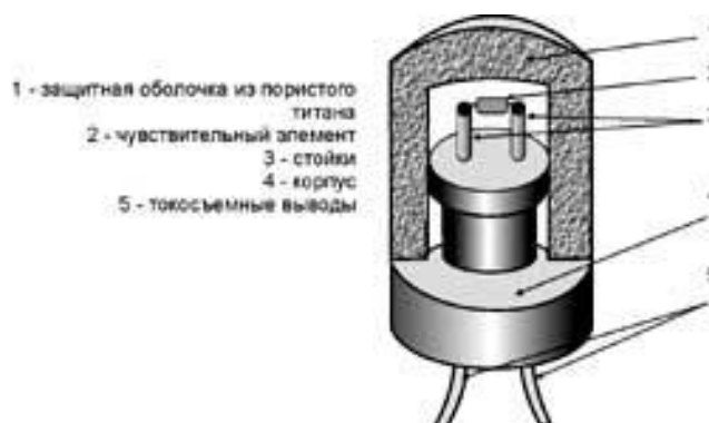
Рис. 3. Структура полупроводникового датчика газа
