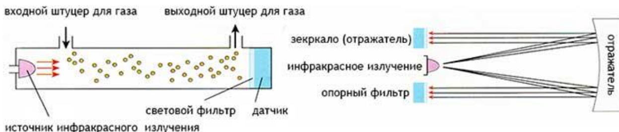
Рис. 4. Принцип работы инфракрасного датчика
