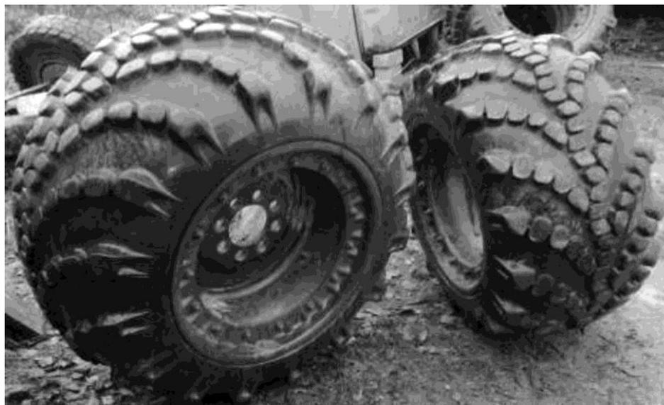
Рисунок 2. Арочные шины
