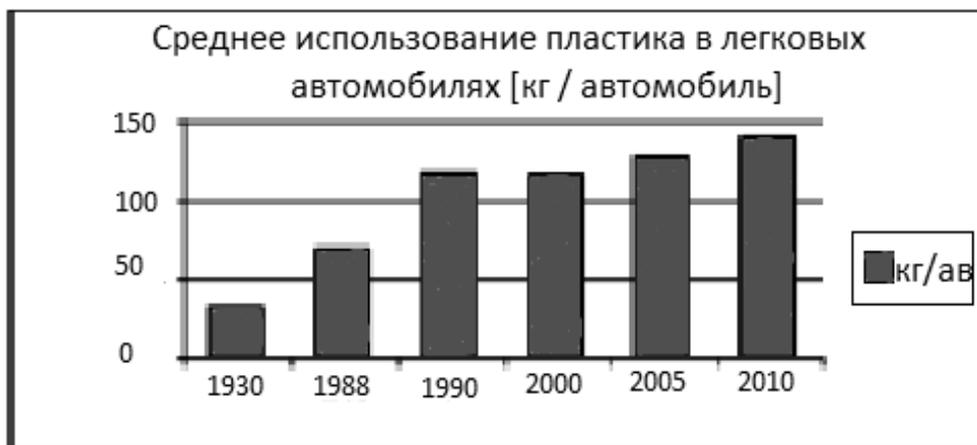
Рисунок 1. Количество пластмасс, используемых в производстве средней легковой автомобиль
