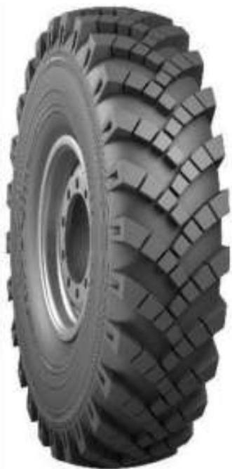
Рисунок 1. Тороидная шина регулируемого давления
