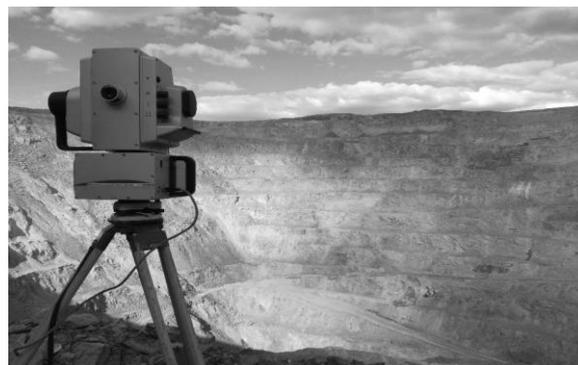
**Рисунок 2. Лазерный сканер Leica HDS8800 на борту карьера «Акбастау»**
