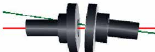
Рис. 1 Виды несоосности: a – параллельная несоосность б – угловая несоосность
