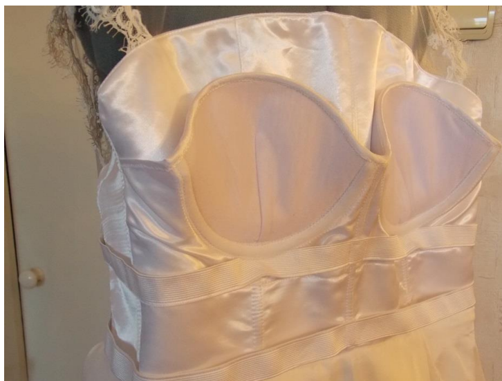
Рисунок 5 – Макет лифа женского платья для торжественных случаев на корсажной основе (вид изнутри спереди)
