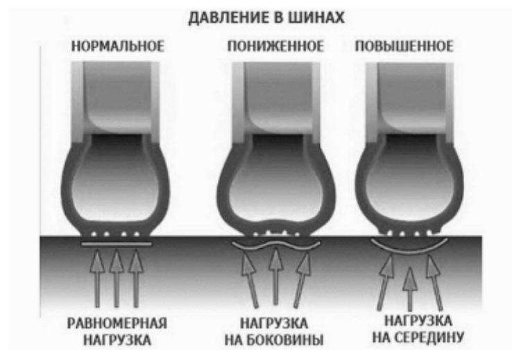
Рис. 1. Зависимость сцепления шин с дорогой от давления в них
