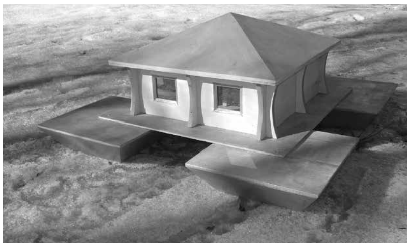
Рисунок 1. Вид сооружения на грунте с понтонами типа 1
