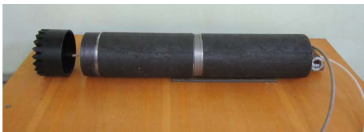
Рисунок 2. Общий вид электрогидроимпульсного бура
