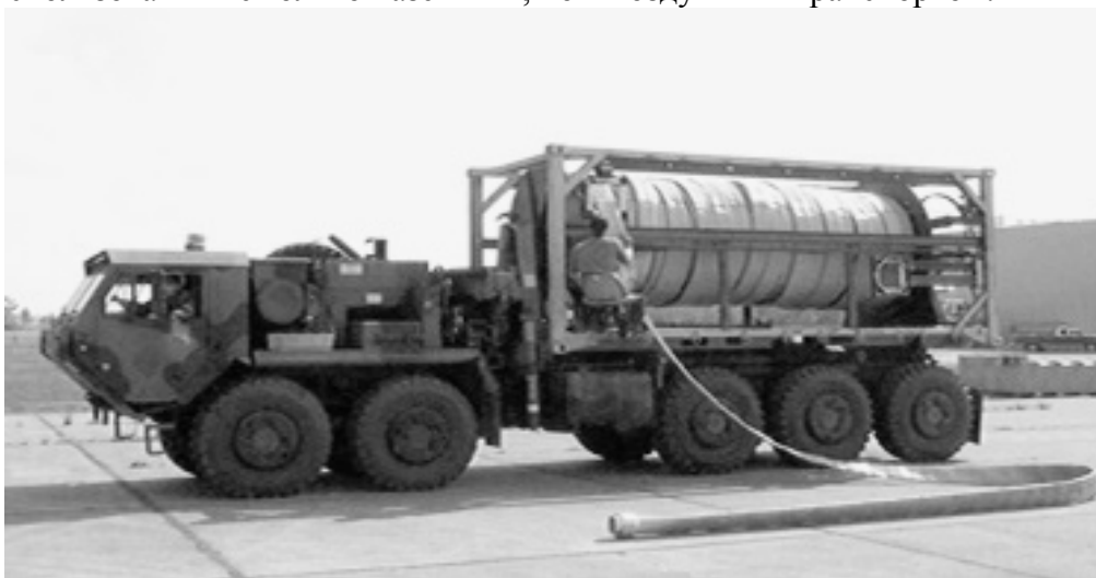
Рисунок 5 – Плосковорачиваемый трубопровод армии НАТО
