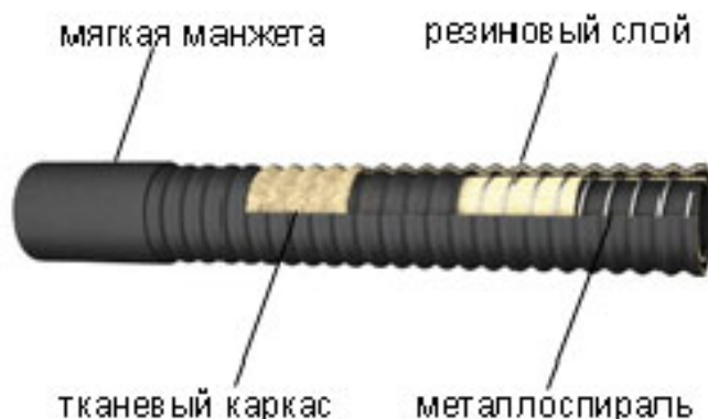
Рисунок 2 – Конструкция антистатического напорно-всасывающего рукава
