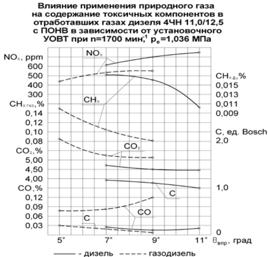
Рис. 1. Влияние применения ПГ на содержание токсичных компонентов ОГ дизеля 4ЧН 11,0/12,5 с ПОНВ в зависимости от изменения установочного УОВТ при n = 1700 \text{ мин}^{-1} , p_e = 1,036 \text{ МПа} ; — — — — — дизельный процесс, — — — — — газодизельный процесс
