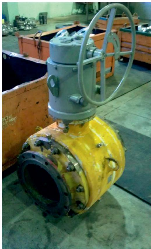
Рис. 1. Привод шарового крана
