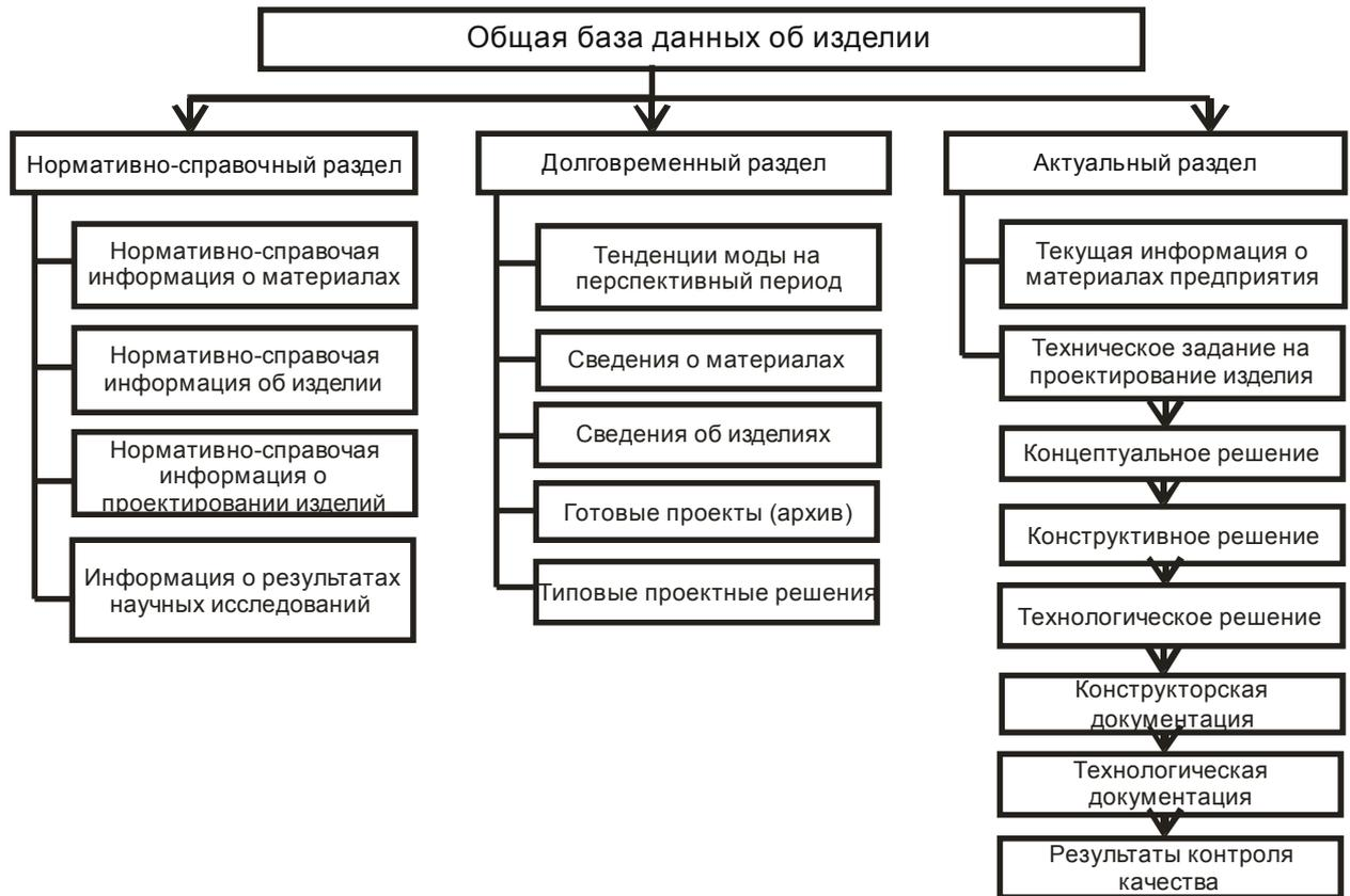
Рисунок 4.1 – Общая структура ОБДИ производства одежды
