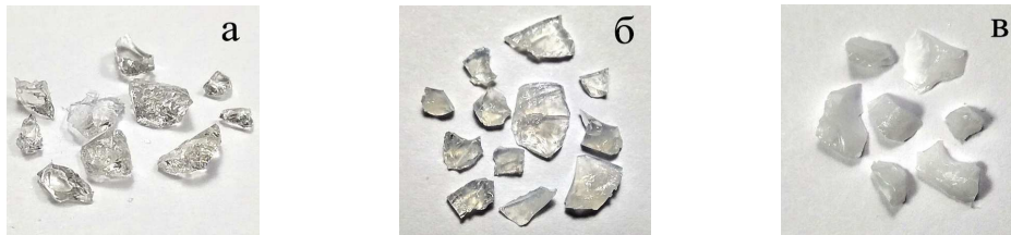
Рис. 3.77. Фотографии биостекел, содержащих 0% (а), 3% (б) и 9% (в) вольфрама
