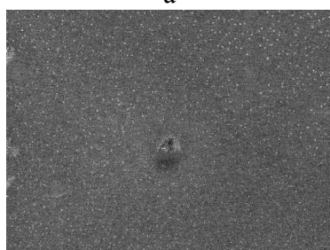
Рис. 3.85. Микрофотография биостекла с 5% \text{Bi}_2\text{O}_3 (а; б) и 3% \text{Ta}_2\text{O}_5 (в; с): до (а; в) и после (б; с) пребывания в SBF-растворе
