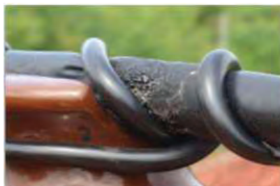
Рис. 3. Электрическая эрозия защитной оболочки провода вблизи крепления к фарфоровому изолятору
