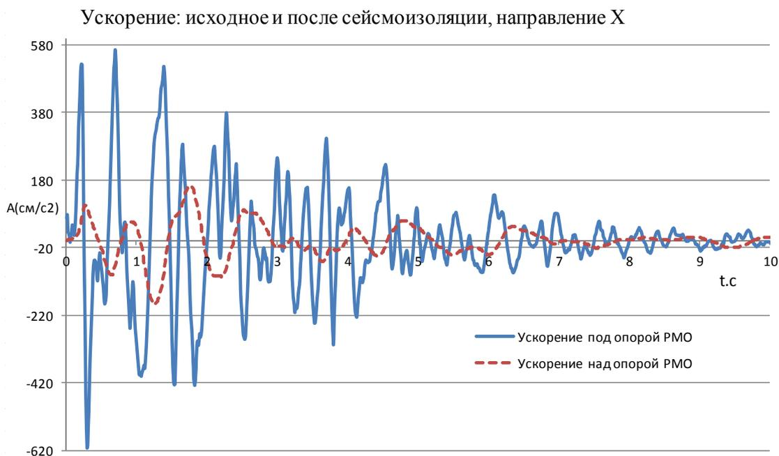
Рис. 5. Ускорение фундамента и надземной части. Синтезированная акселерограмма.
