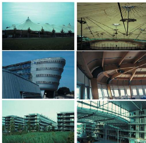
тектурная и строительная форма представлены в разных материалах. Интерьер представлен деревянными балками, с закругленными вершинами, в то время как, фасад – остроугольное судно. Рациональное использование нескольких конструктивных систем позволяет достичь компромисса. Вертикальные железобетонные стены обеспечивают боковую устойчивость, внутренние колонны поддерживают верхние этажи, а изогнутые клеёные рамы завершают сложную конструктивную композицию.
