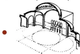
Развитие цилиндрического свода, Месопотамия. Тростниковые балки были покрыты цинковками
