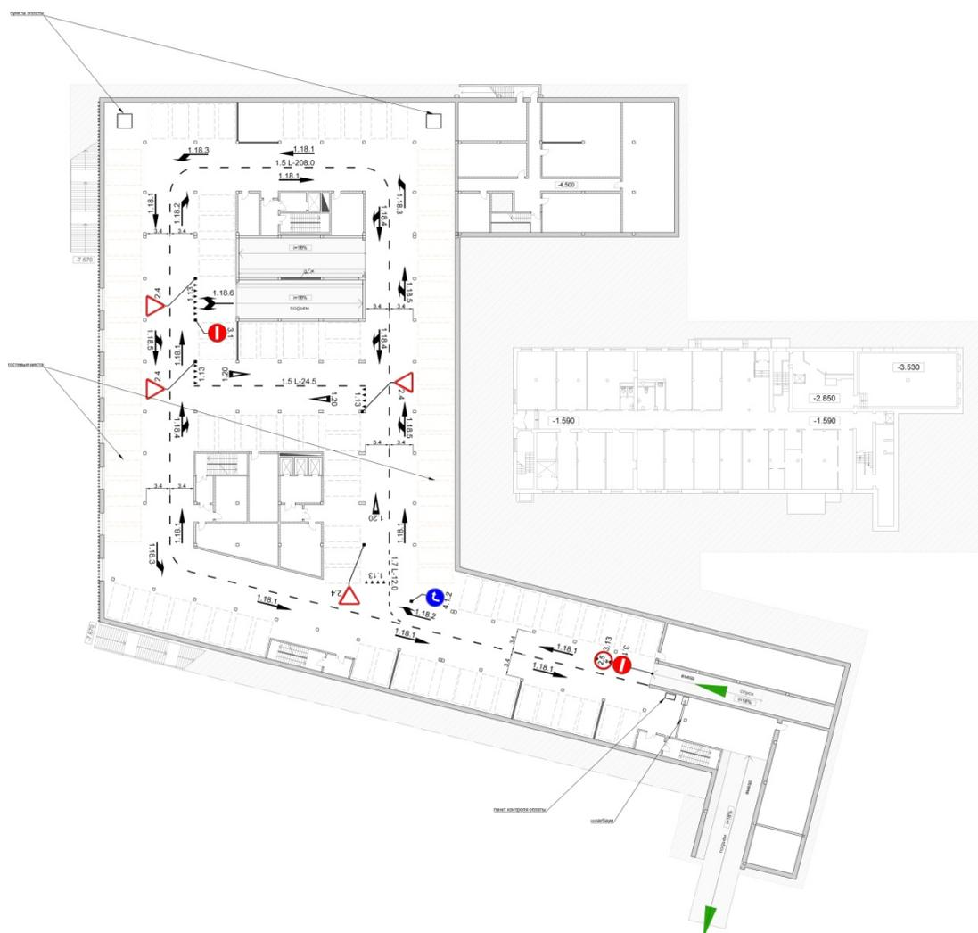
Рисунок 2 – Вариант организации движения внутри паркинга
