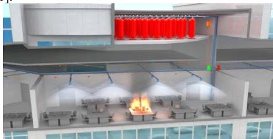
Рисунок 4.1 Автоматического установка водяного пожаротушения с тонкораспыленной водой
