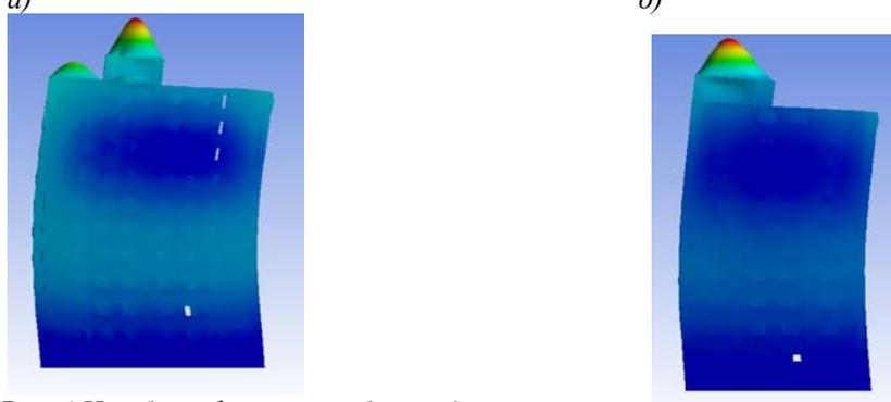
а – вид в осях «А-Е» 4-ой моды с частотой 14.891 Гц и периодом 0.067155 с;
