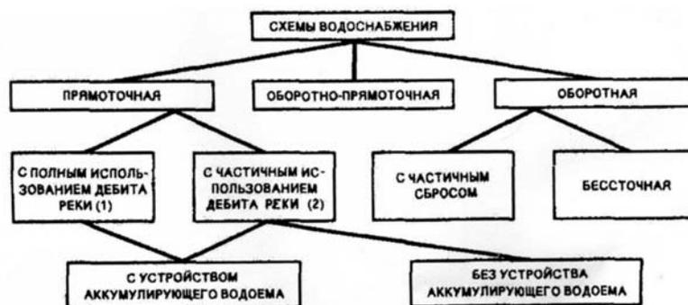
Рисунок 1 - Классификация схем водоснабжения при разработке россыпей.
