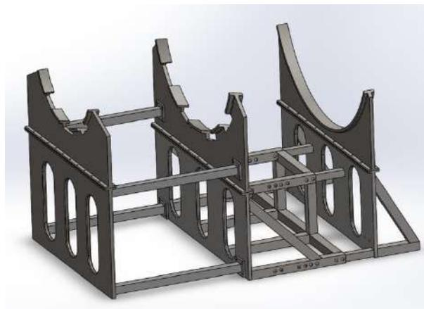
Рис. 3. Общий вид универсальной сборочной рамы с дополнительной опорой
