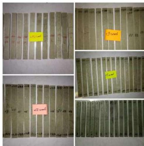
Рис. 4. Образцы для проведения испытаний на растяжение группы В
