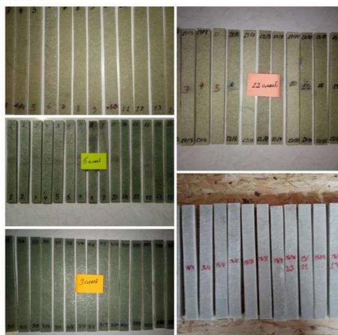
Рис. 3. Образцы для проведения испытаний на растяжение группы А
