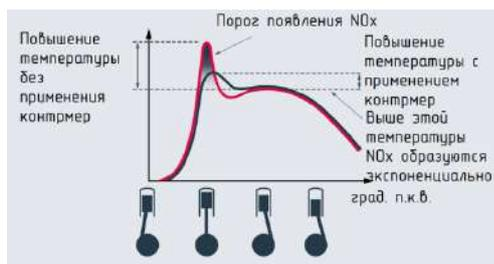
Рис. 2. Зависимость уровня выбросов  $NO_x$  от значения пиковых температур в рабочем цилиндре двигателя
