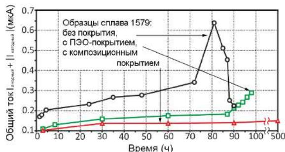
Рис. 3. Изменение суммы общих катодных и анодных токов для трех образцов из алюминиевого сплава (без покрытия, с ПЭО-слоем, с композиционным полимерсодержащим покрытием)
