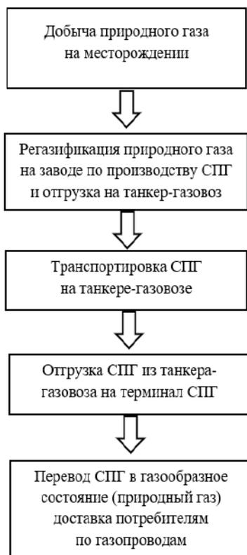
Рис. 1 Процесс от добычи природного газа до его доставки потребителям с помощью танкеро-газовозов
