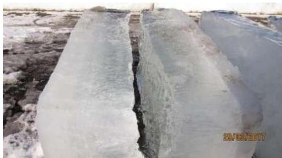
Рис. 7. Результат разрушения монолита льда струями ВСМФС из ствола-пики
