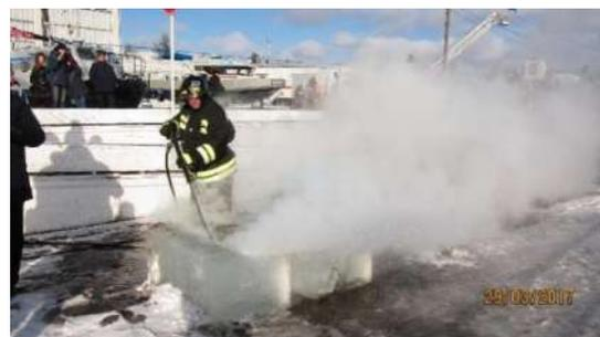
*Рис. 6. Работа ствольщика по разрушению монолита льда струями ВСМФС из ствола-пики*
