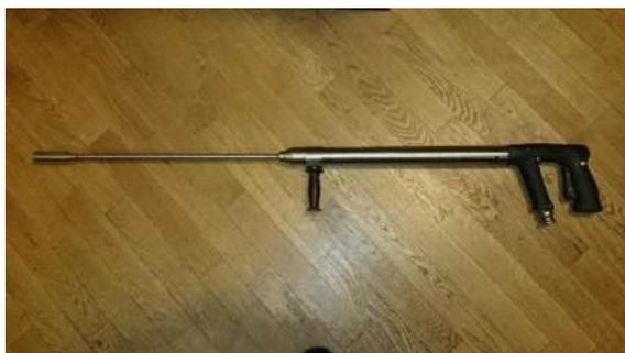
*Рис.3. Ствол-пика с насадком для разрушения льда ВСМФС. Длина трубы перед насадком может быть увеличена до 6 метров*
