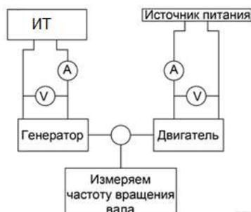
Рисунок 4. Схема стенда для второго этапа исследований
