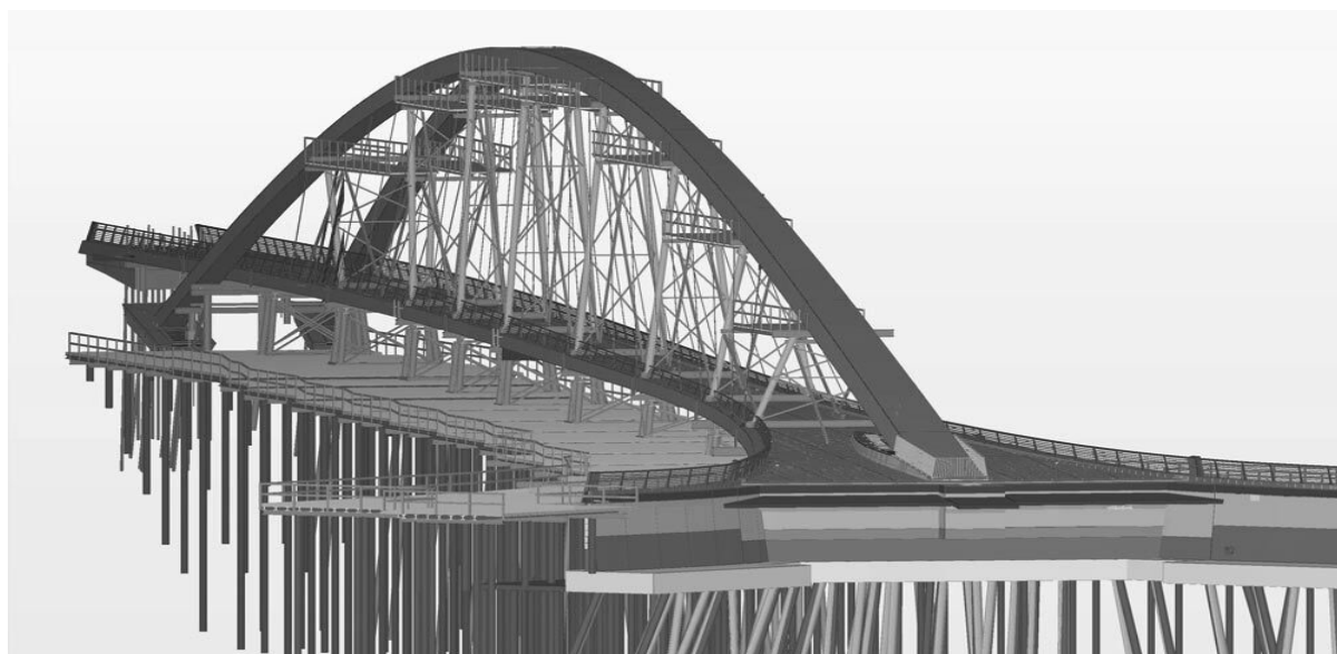
Рис. 2. Конструкция моста, выполненной в программе BIM
