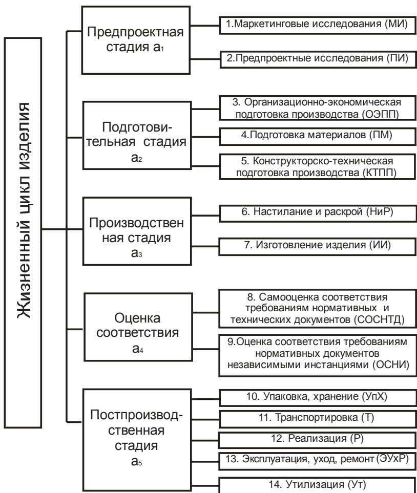
Рис. 4.4. Обобщенная структурная модель ЖЦ одежды
