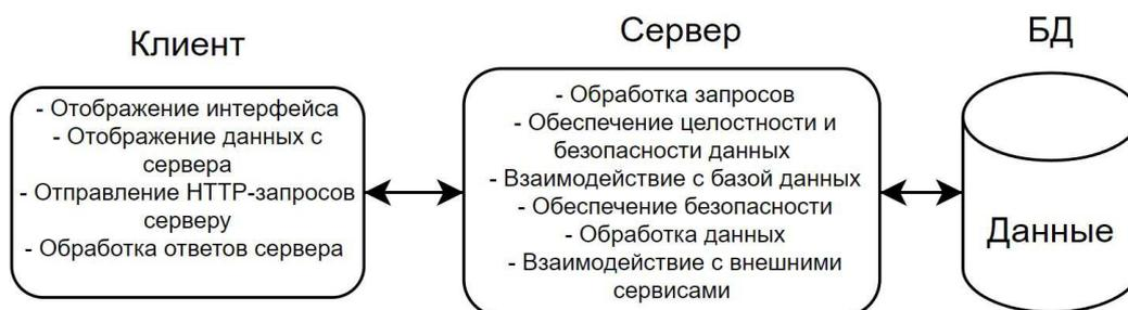
Рис. 3. Устройство архитектуры
