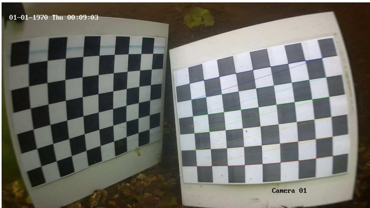
Рис. 10. Автоматически определенные границы шахматной доски
