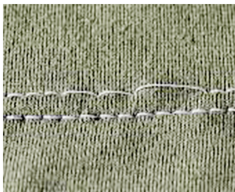
Рис. 1. Внешний вид строчки при нарушении процесса петлеобразования
