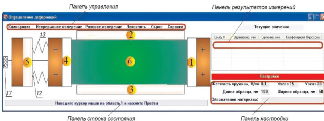
Рис. 3. Интерфейс программы «Определение деформационных параметров» волокнистых систем
