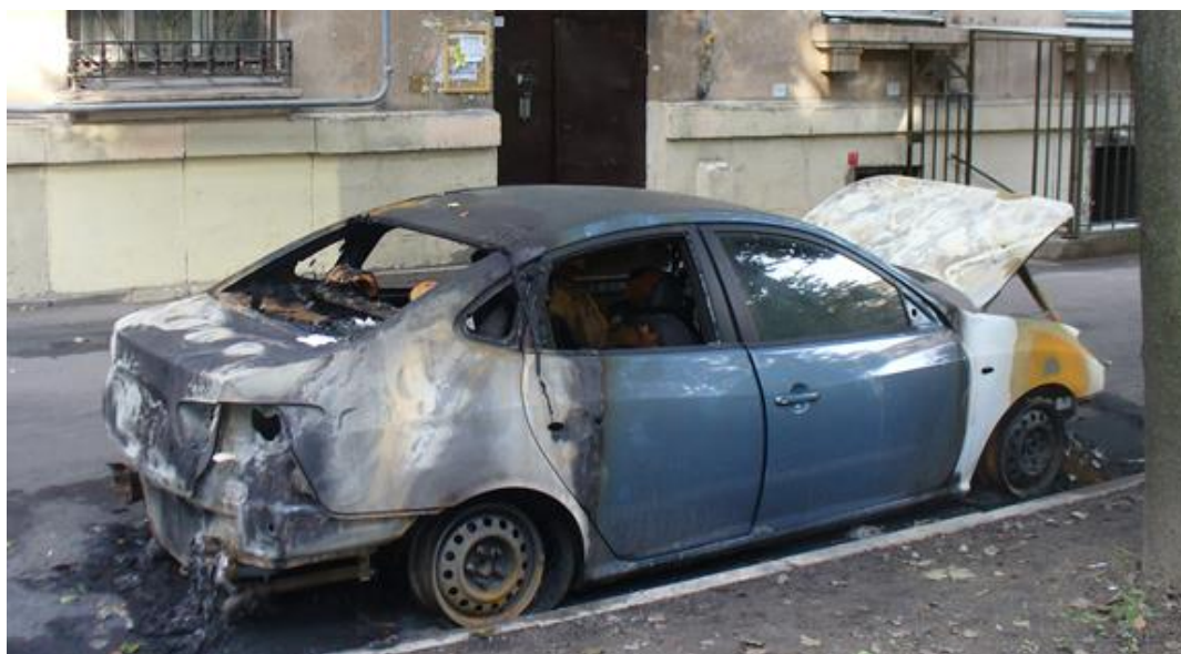
Рис. 2. Две зоны термического воздействия на легковой автомобиль
