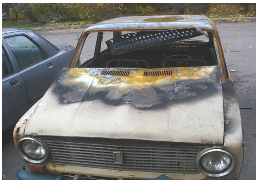
Рис. 1. Деформированная крыша легкового автомобиля над очаговой зоной
