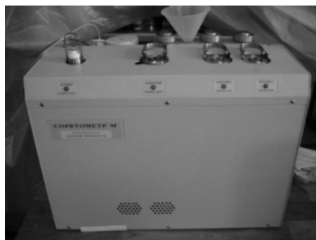
Рис. 1. Внешний вид анализатора «Сорбтометр М»
