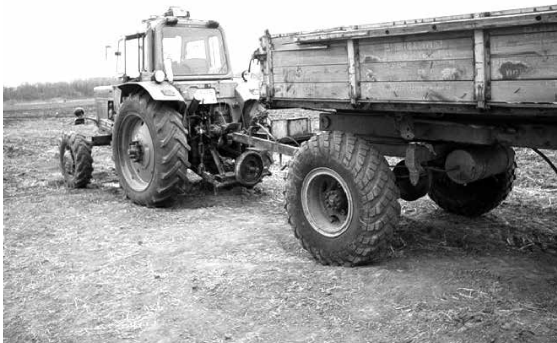
Рисунок 2. Трактор МТЗ-82 с дополнительным маховиком
