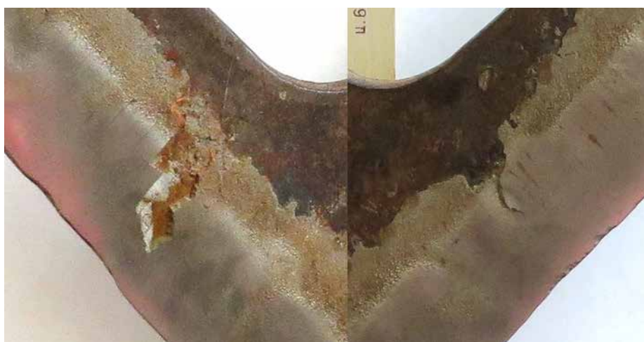
Рисунок 2. Развитие возникающих дефектов износостойкого покрытия на момент выбраковки экспериментальной СЛ
