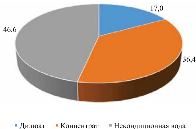
Рисунок 3. Распределение нефтепродуктов, поступающих с исходной водой, по выходящим потокам (средние значения)
