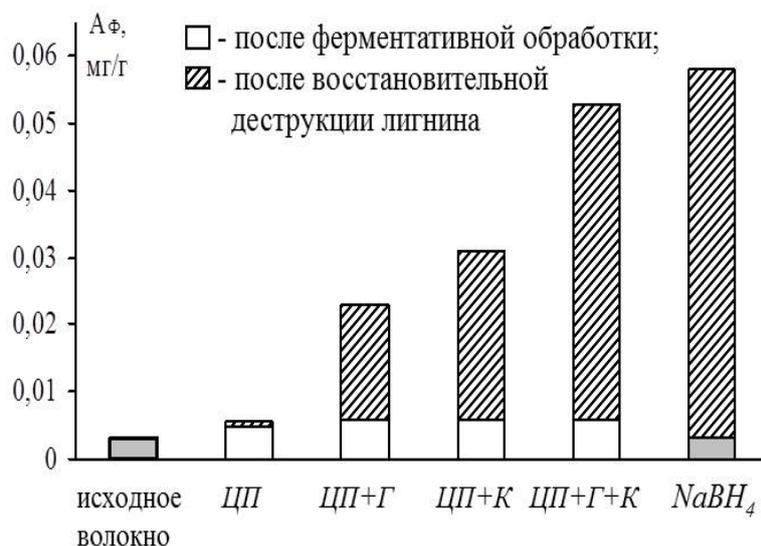
Рис.1. Сопоставление равновесного поглощения фенола исходным льняным волокном и образцами, подвергнутыми воздействию ферментных препаратов и борогидрида натрия
