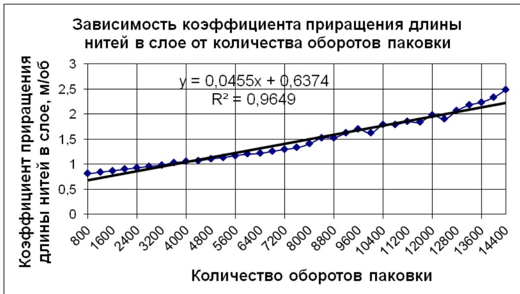
Рис. 2. Зависимость коэффициента приращения длины нитей в слое от количества оборотов паковки при аппроксимации экспериментальных данных полиномом первого порядка
