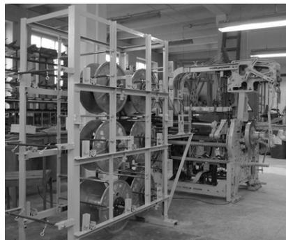
Рис. 5. Фотография экспериментального станка для выработки 3D текстильных армирующих наполнителей повышенной толщины с произвольным видом переплетений нити
