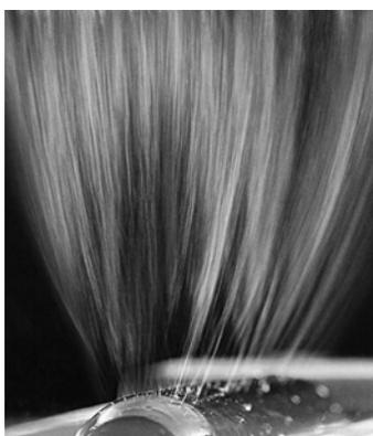
Рис. 1. Формирование жидкой струи на формовочном электроде установки NS-LAB 200 Nanospider
