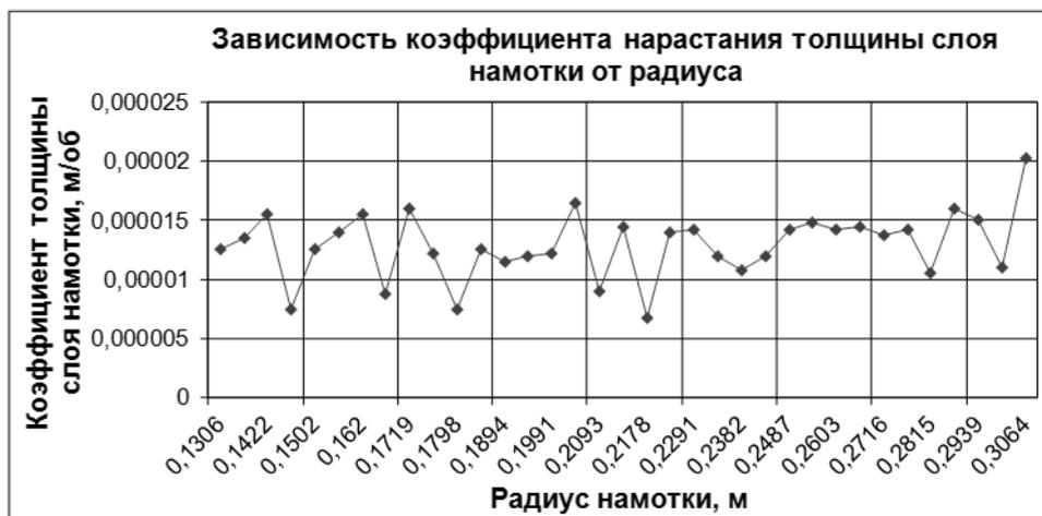
Рис.1. Закономерность изменения коэффициента нарастания толщины слоя намотки
