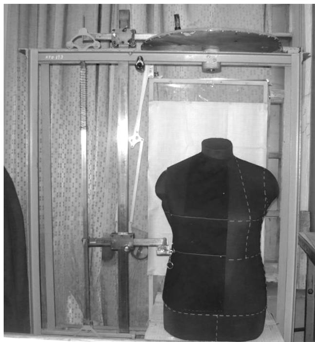
Рис. 3. Установка Л.П. Юдиной для измерения параметров силуэта фронтального контура одежды
