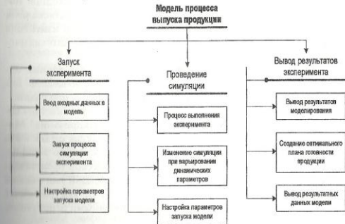
Рис. 2. Модульная структура процесса планирования выпуска продукции
