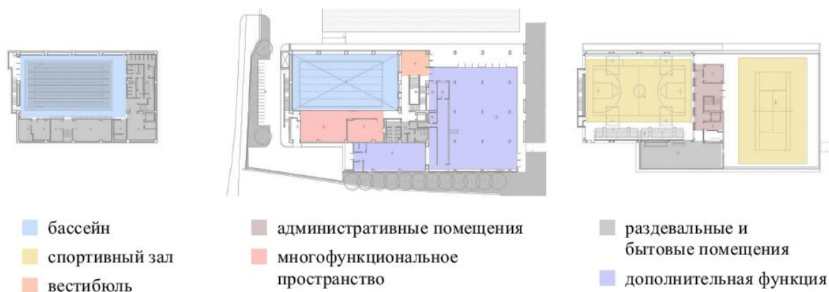
Рис. 6. Функционально-планировочная схема спортивного комплекса американской школы «Гаосюн» [6]
