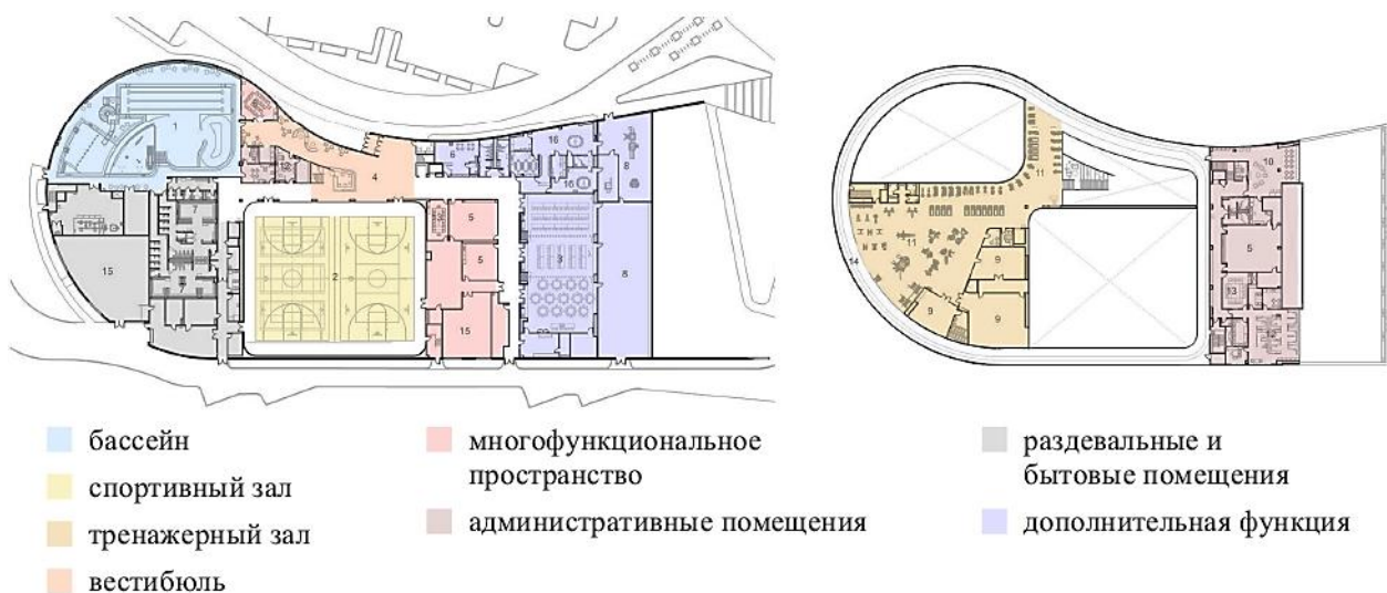
Рис. 4. Функционально-планировочная схема общественного центра отдыха в «Мэриленд-Хайтс» [5]
