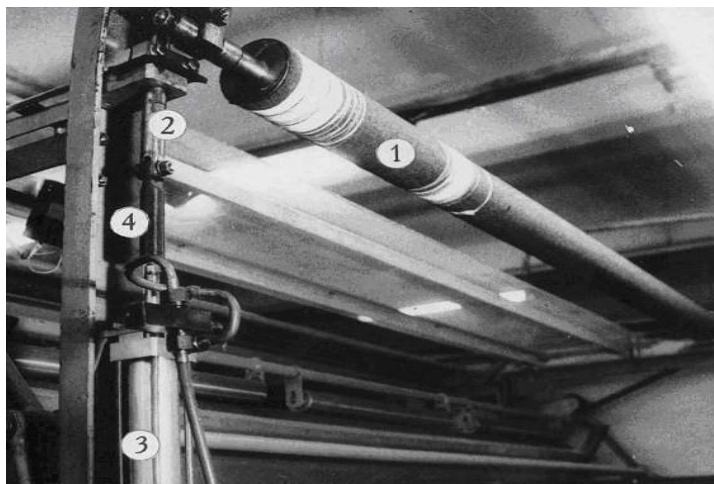
Рисунок 3.13 - Экспериментальная конструкция механизма одновалковой системы ориентации: 1 - рабочий орган; 2 - шток пневмоцилиндра, 3 - демпфер; 4 - соединительная штанга
