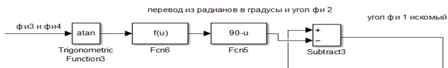
Рис.5. Структурная схема вычисления угла поворота судна \angle\varphi_1
