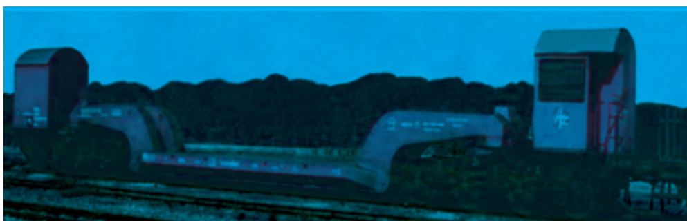
Рис. 12. Специализированный вагон серии «У» для перевозки негабаритных грузов
