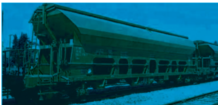
Рис. 4. Крытый четырехосный вагон с раздвижной крышей серии «Тад»
