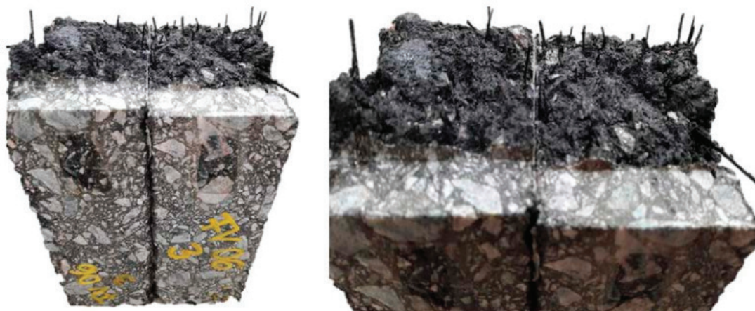
Рис. 12. Вид поверхности разрушения после испытаний на изгиб
