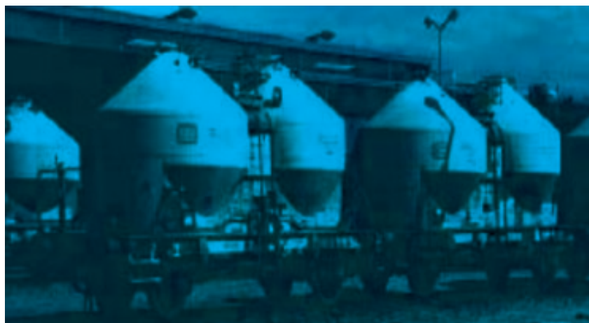
Рис. 13. Специализированный вагон серии «У» для перевозки гранулированного и мелкодисперсного грузов
