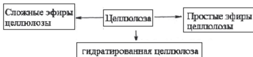
Рис. 3. Схема получения полимерных материалов из целлюлозы
