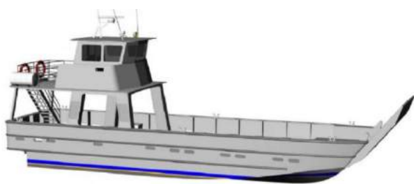
Рис. 12. Судно для доставки пассажиров и накатной техники на необорудованный берег (www.boatsonline.com.au)
