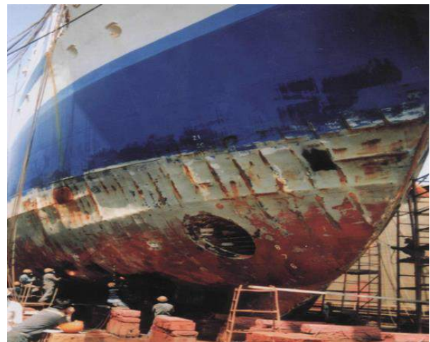
Рис.2. Пример тяжёлых ледовых повреждений судна при самостоятельном плавании
