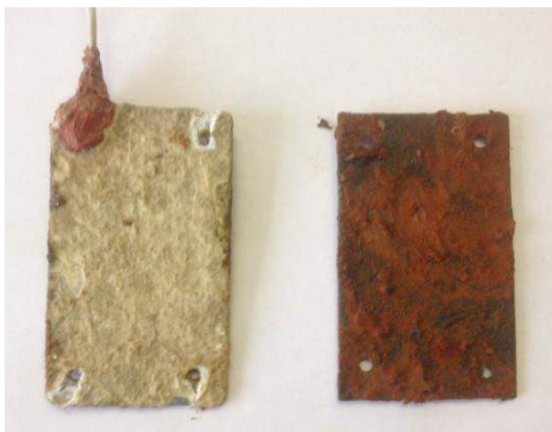
Рис.3. Внешний вид образца, находившегося под катодной защитой (слева) и контрольного образца (справа)
