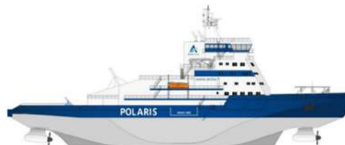
Рис. 8. Проект многофункционального ледокола «Polaris» (Финляндия) по проекту Aker ARC 130, с использованием природного газа в качестве топлива ( http://arctia.fi )
