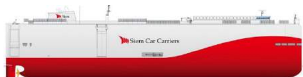
Рис. 8. Паром-автомобилевоз, использующий в качестве топлива сжиженный природный газ, по проекту Houlder's Marine Design Consultancy, Великобритания
