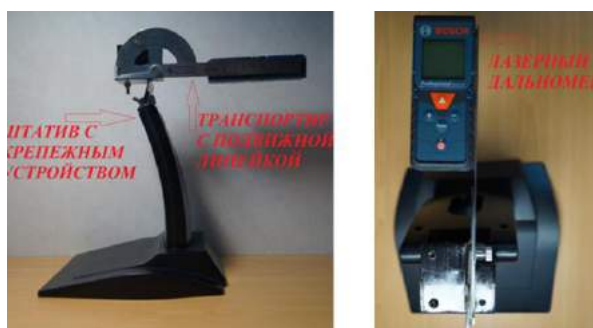
Рис. 3. Экспериментальная модель лазерного устройства судовой системы лазерной швартовки
