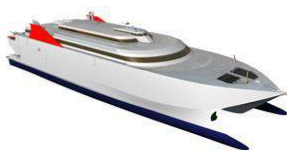
Рис. 11. Быстроходный грузопассажирский паром катамаранного типа с малой площадью ватерлинии компании Incat, Тасмания
