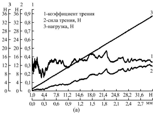
Рис. 2. Зависимость коэффициента трения от нагрузки при испытаниях исходной поверхности (а) и карбидсодержащего слоя (б).
