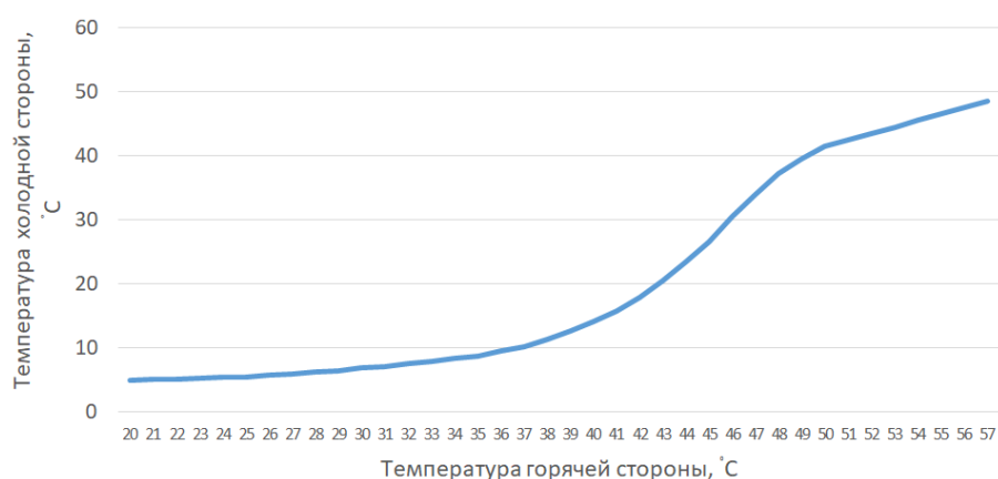
Рисунок 4 – График зависимости изменения температуры горячей стороны ТЭМ от температуры холодной стороны
