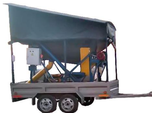
Рис. 5. Изготовленное мобильное устройство для сушки шала
