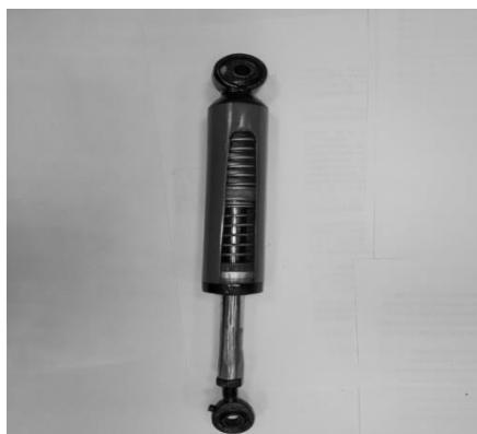
Рис.3. Механический однотрубный амортизатор
