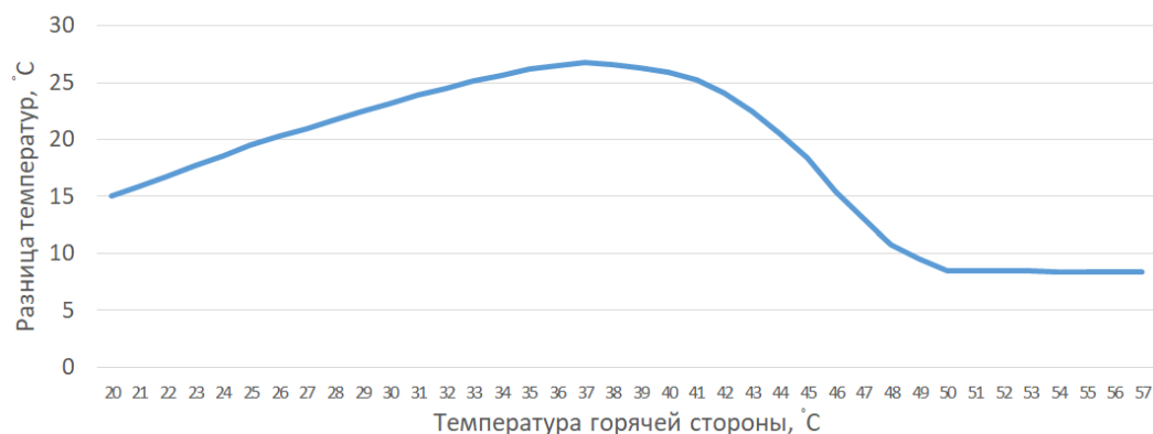
Рисунок 5 – График зависимости изменения температуры горячей стороны ТЭМ от \Delta T
