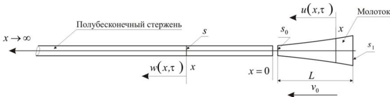
Рисунок 1. Расчетная схема к задаче генерирования импульса продольной динамической деформации молотком, имеющим форму пауэра
