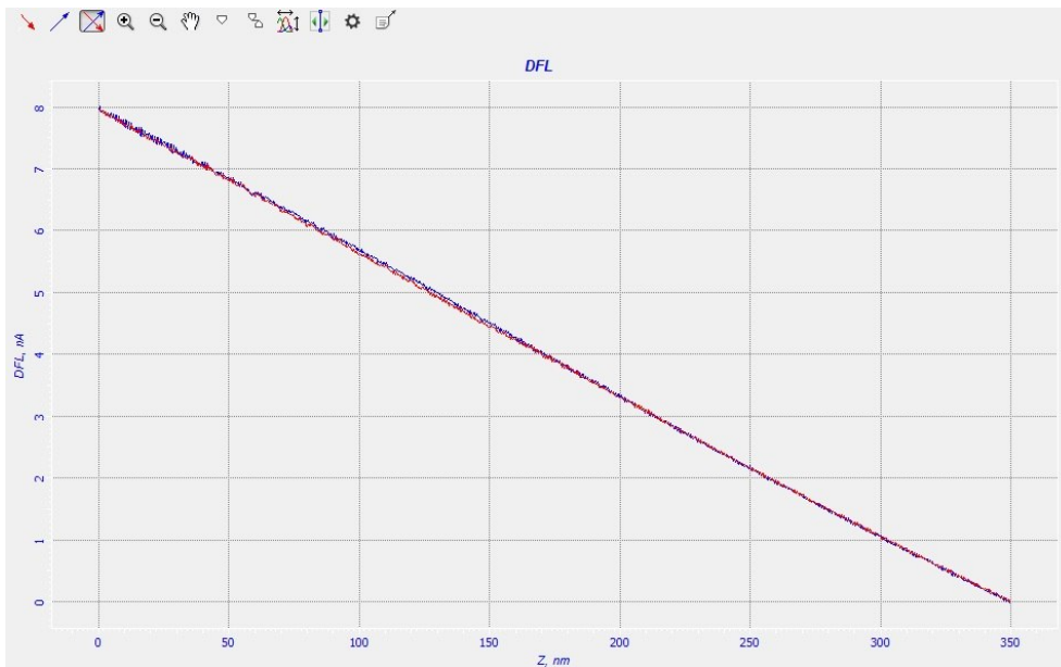
Рис.4. Кривая спектроскопии «подвод-отвод» для образца 79 МН R. Эффект залипания.
