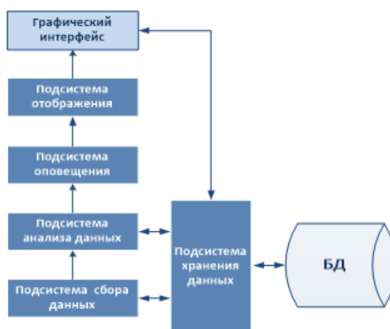
Рисунок 1 – Архитектура системы мониторинга и аудита
