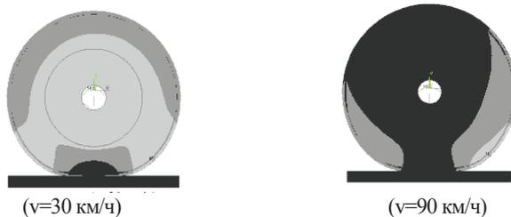
Рис. 4. - Характер деформирования пневматической шины при стационарном качении с различной скоростью.
